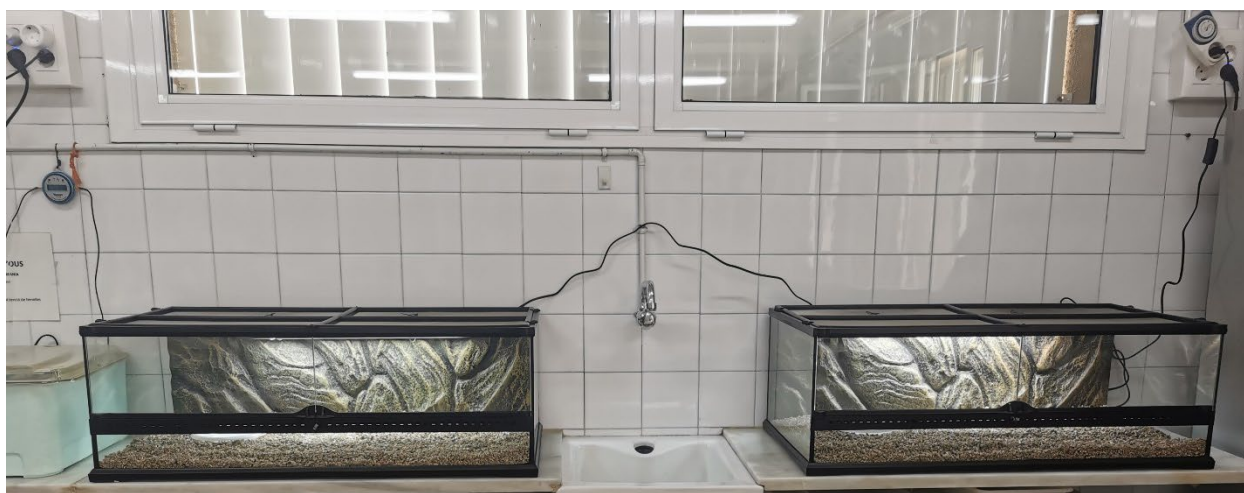
Figura 8. Imatge dels nous terraris, situats al laboratori de biologia, comprats el 2023. Les mesures són 90 cm d'amplitud, 31 cm d'alçada i 45cm de fons. Al sostre de cada terrari hi ha un fluorescent, amb una potència de 24W i amb un percentatge de radiació ultraviolada optimitzada per a rèptils d'aquestes característiques. Els dos fluorescents estan connectats en paral·lel (per mantenir exactament les mateixes característiques en els dos terraris) a un rellotge temporitzador, que permet seleccionar les hores de llum. Com en anys anteriors, al fons hem col·locat el mateix substrat (cànem premsat).
