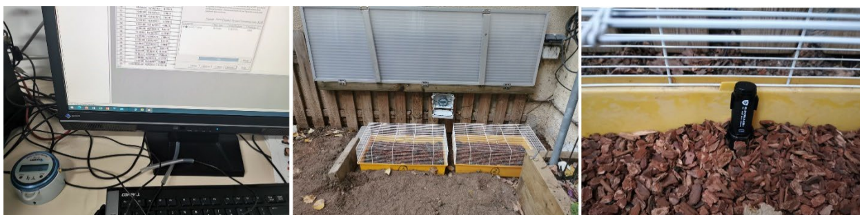
Figura 9. Lector dels dataloggers Escort iLog connectat a l'ordinador per poder programar i descarregar dades (esquerra), situació del datalogger Escort iLog de doble sonda tèrmica a sobre les caixes d'hibernació (al mig) i dels EasyLog d'humitat i temperatura a l'interior de cada una de les caixes (dreta). (Imatge extreta de Clàudia Guerra, 2022).
